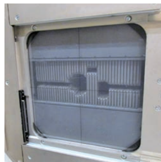
マルチリーフコリメータによるX線照射野作成
